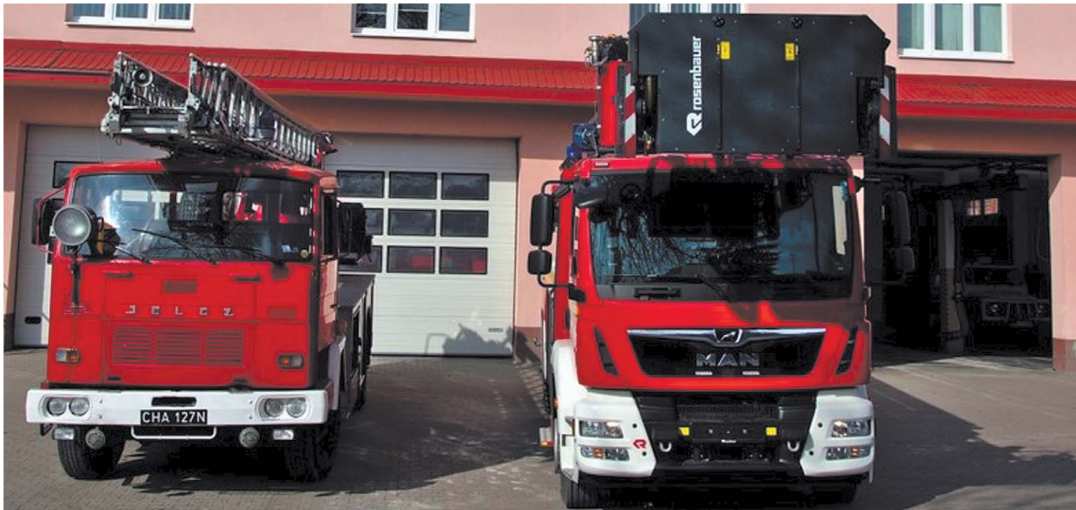
Jelcz służył chełmskim strażakom 42 lata. Teraz mają nowy pojazd z tzw. łamanym przęsłem, co znacznie ułatwia prace na wysokości
