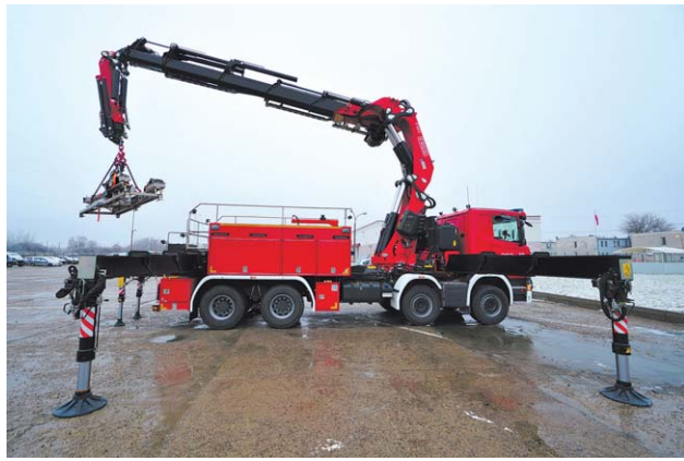
Pojazd ma 10,5 m długości, 4 m wysokości i 2,65 m szerokości. Jego masa całkowita to 46 ton
