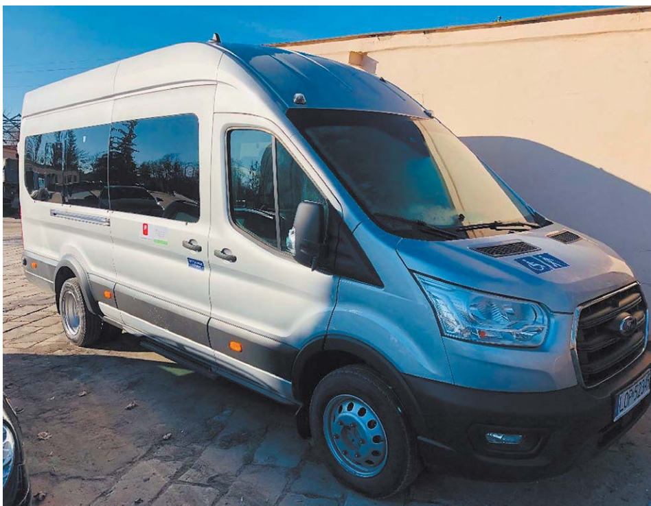
Pojazd jest wyposażony m.in. w specjalistyczną windę hydrauliczną do wprowadzania wózka inwalidzkiego
