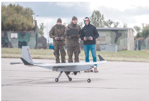
Punisher to statek bojowy, umożliwia rażenie przeciwnika zdalnie naprowadzaną amunicją
