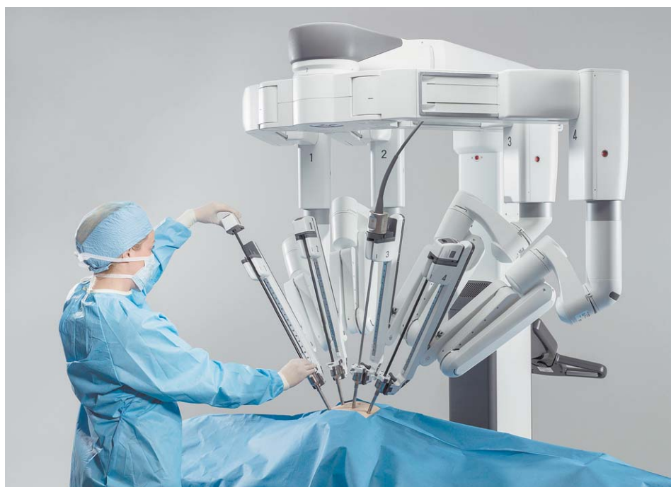
Robot składa się z dwóch części: konsoli chirurgicznej, odpowiadającej za sterowanie i robota właściwego z kilkoma ramionami
