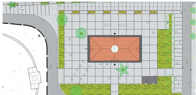
Tak wygląda projekt nowego Rynku w Końskowoli. Oprócz granitowej nawierzchni, nie brakuje urządzonych trawników i nowych nasadzeń. Część starych drzew zostanie jednak usunięta lub przesadzona
