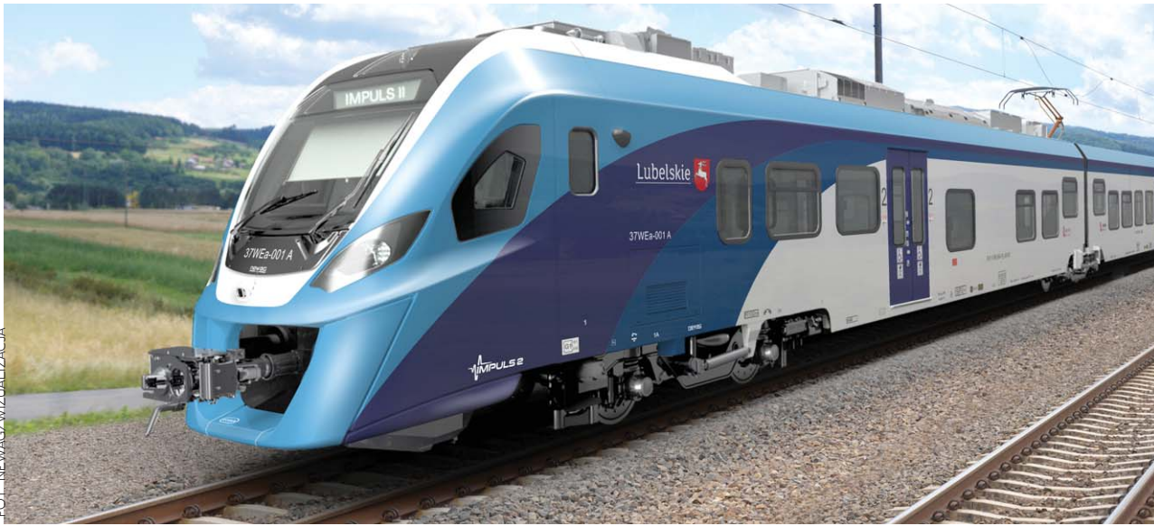
Impulsy będą zaprojektowane tak, że w przyszłości będzie można je rozbudować, wstawiając do środka jeden lub dwa człony
