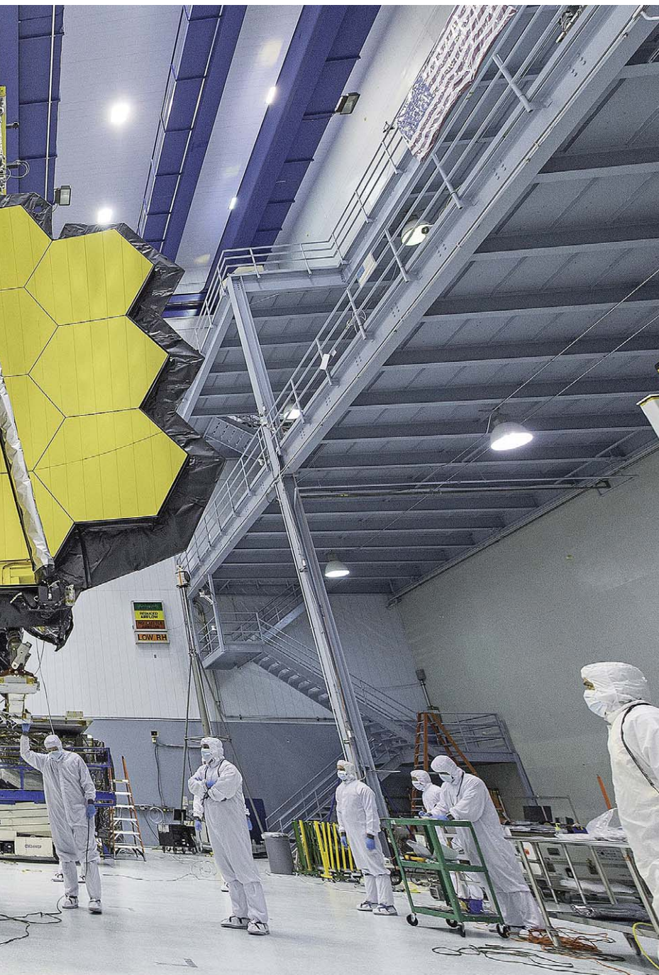
Zwierzciadło Teleskopu Webba jest zbudowane z 18 sześciokątnych segmentów
