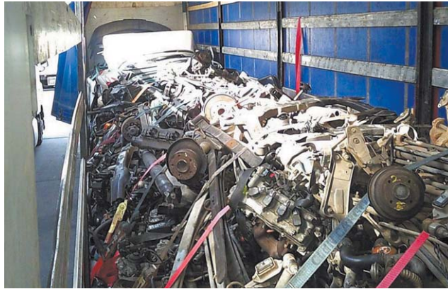
Ładunek 19 części z demontażu silników, w tym odpady niebezpieczne objęte zakazem wywozu poza UE i kraje OECD
