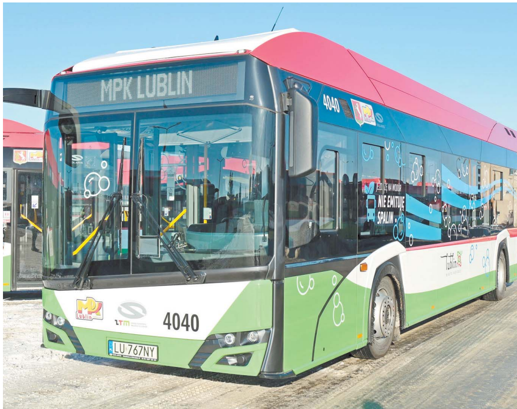
Wodorowy Solaris Urbino 12 Hydrogen. Zasięg tego autobusu wynosi od 350 do 400 km
