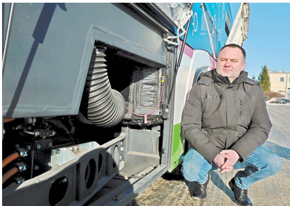
Z wodoru wytwarzana jest energia elektryczna, ta energia przechowywana jest w buforze energii, jakim jest bateria trakcyjna autobusu – mówi dr inż. Piotr Hołyszko, kierownik Zakładu Autobusowego MPK Lublin
