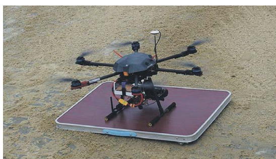
Dron z kamerą termowizyjną pozwala wykonać inspekcję podziemnej infrastruktury
