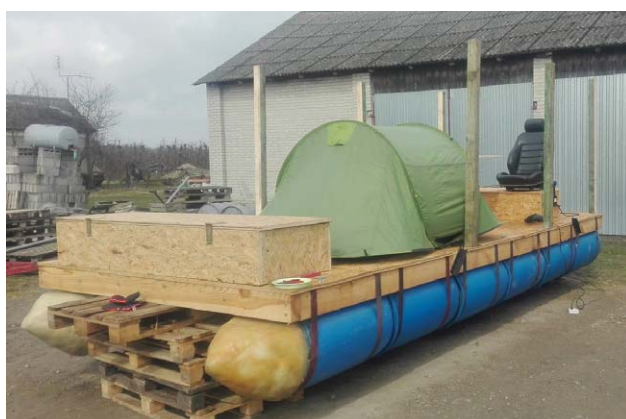
Tratwa z 2 plastikowych beczek i drewna. Długość to ok. 6 metrów, a szerokość: 2,5 metra
